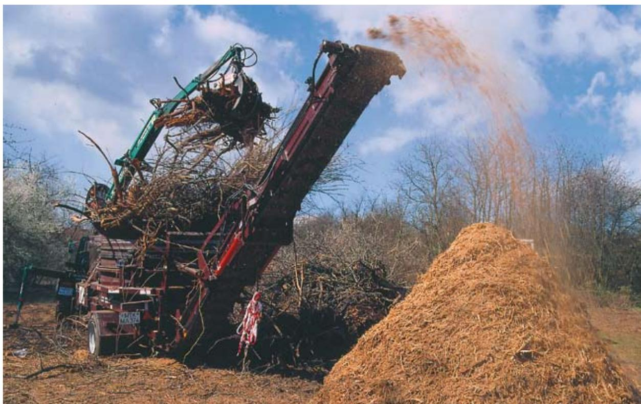
**Schreddern von Wurzel- und Astwerk als Ausgangsprodukt für die Kompostierung bzw. als Abdeckmulch.**
